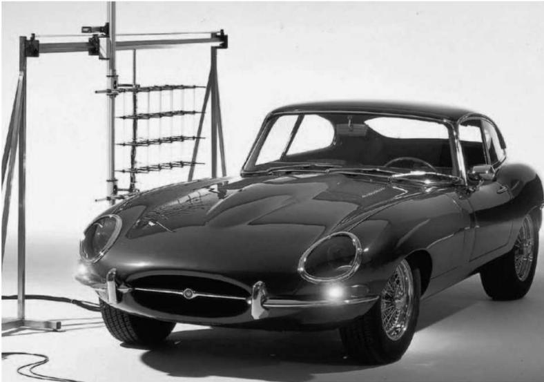
**FIGURE 8.18** Antenne acoustique pour la localisation de sources acoustiques (d'après Mesures [37]).
