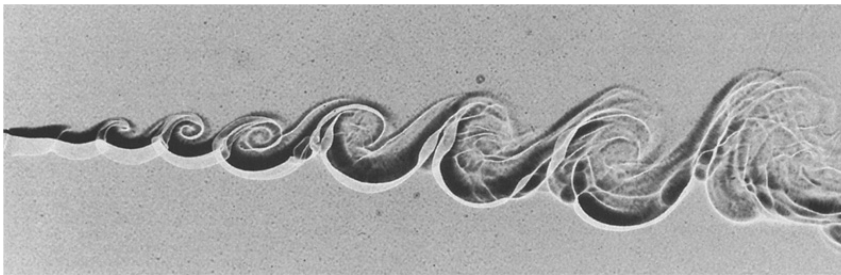
FIGURE 1.2 : Structures cohérentes dans une couche de mélange air/azote (d'après Brown [5]).
