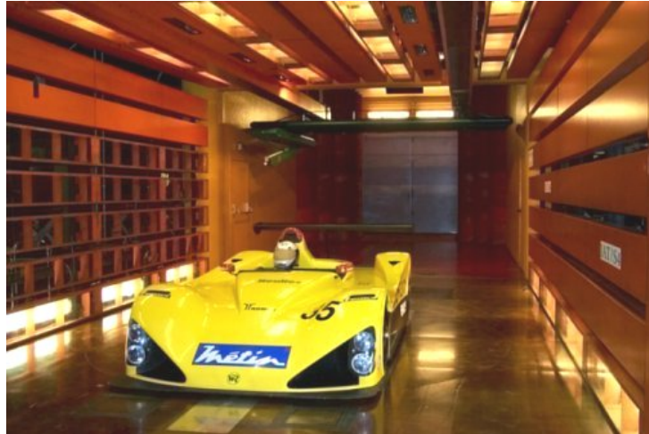
FIGURE 6.39 : Étude aérodynamique d'une voiture de compétition. Photo de la soufflerie S4 de l'Institut AéroTechnique du CNAM (Une balance à 6 composantes, est disposée sous le plancher de la chambre d'expériences. Le véhicule à qualifier repose sur ses roues, sur quatre patins de forme rectangulaire affleurant le plancher et liés au bâti mobile de la balance. Trois dynamomètres à jauges de contraintes, dont les axes de mesure sont dirigés perpendiculairement au plancher, transmettent les poussées verticales à des butées hydrostatiques. Trois autres dynamomètres répartis dans un même plan horizontal et orientés suivant des directions orthogonales privilégiées, sont utilisés pour déterminer les composantes horizontales du torseur des efforts.).
