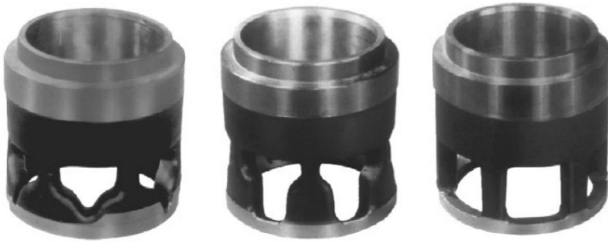
FIGURE 3.3 : Forme de la cage d'un clapet de vanne en fonction du type d'évolution du coefficient C_v relatif (d'après Emerson—Fisher [41]).
