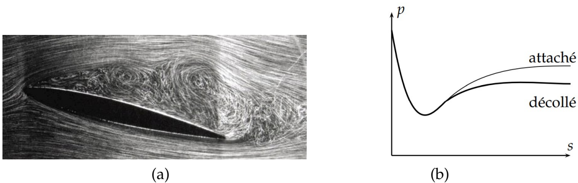
FIGURE 6.8 : a, décollement de la couche limite (Photo ONERA) ; b, distribution de la pression autour d'un obstacle selon le type d'écoulement (attaché ou décollé).
